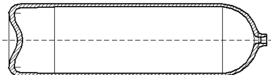
Рис. Принципиальная конструкция баллонов.
